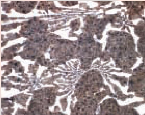
میکروساختار: زمینه مارتنزیتی حاوی کاربیدهای اولیه و ثانویه.
